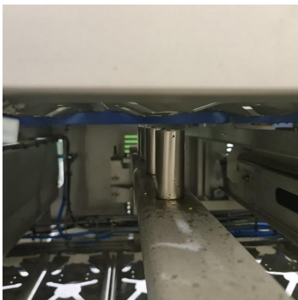
Rys. 104. Widok budowy systemu do wypychania gniazd nasiennych papryki
