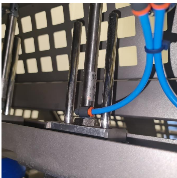
Rys. 101. Widok ogólny a) siłownika tłoczyskowego dwustronnego działania, b) belki dociskającej
