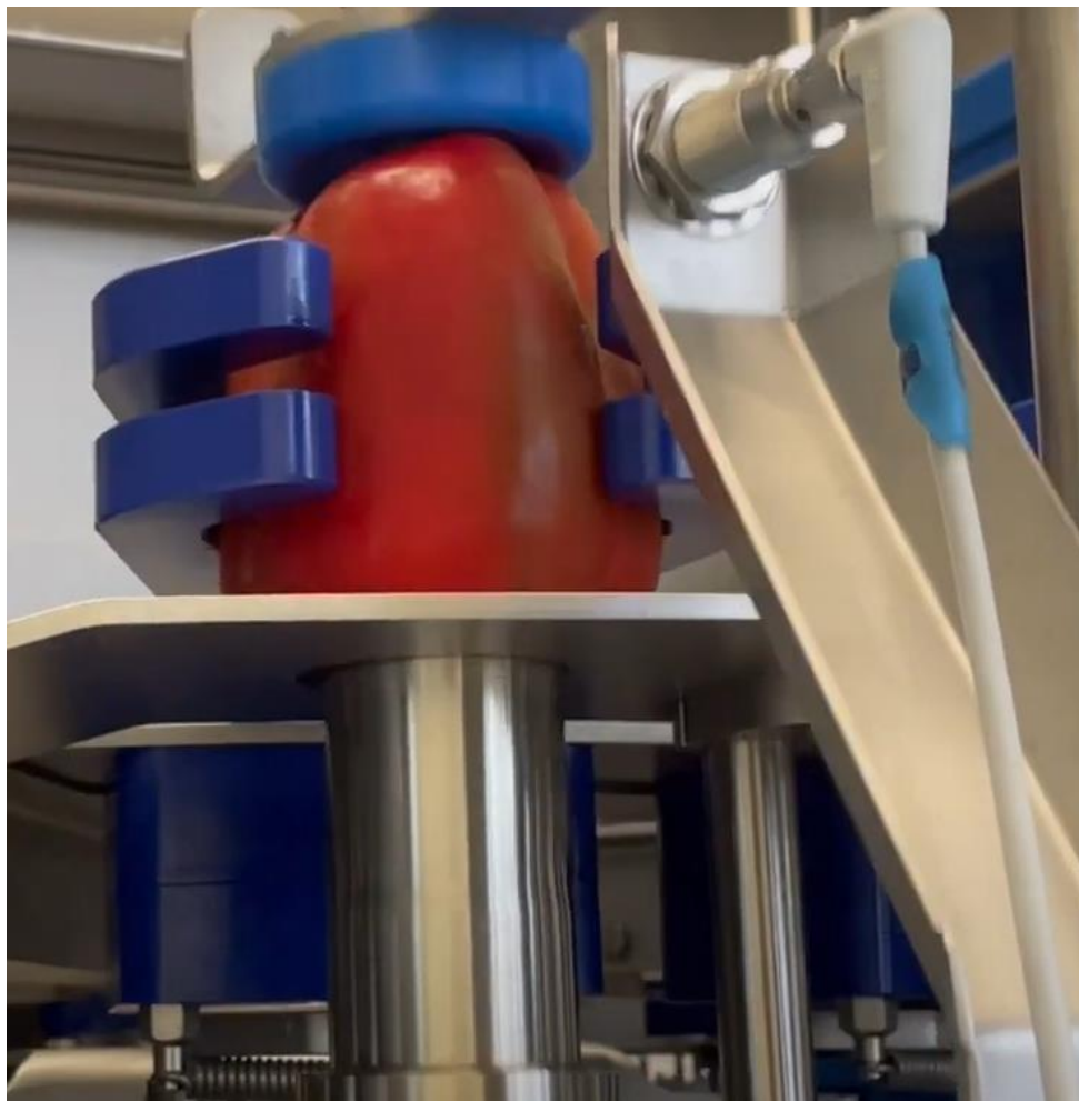
Rys. 13. Widok na cykl pracy maszyny – wycinanie gniazda papryki nożem z dołu [7]
