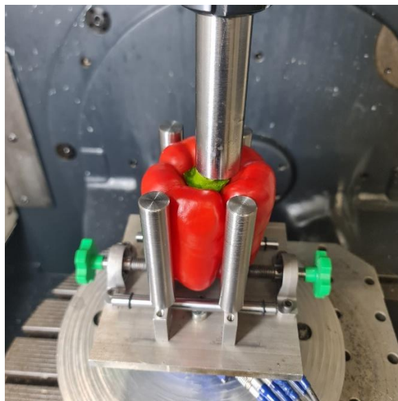
Rys. 55. Widok błędnie ustawionego wypychacza
