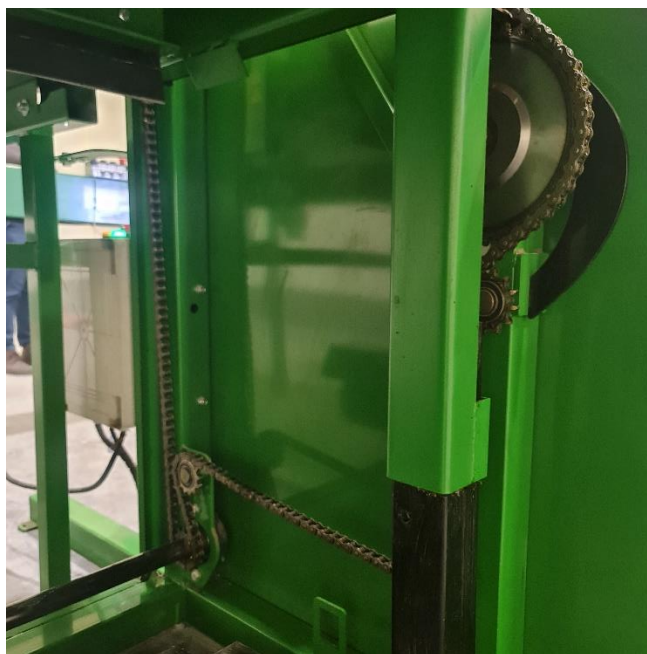
Rys. 110. Widok budowy napędu systemu załadowniczego
