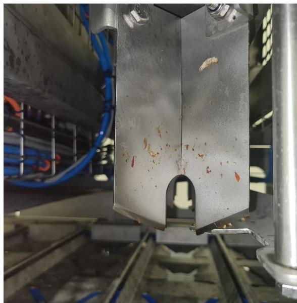
Rys. 105. Widok budowy systemu cięcia papryki
