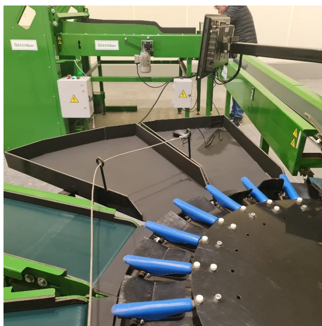
Rys. 112. Widok budowy układu wykonawczego sortera
