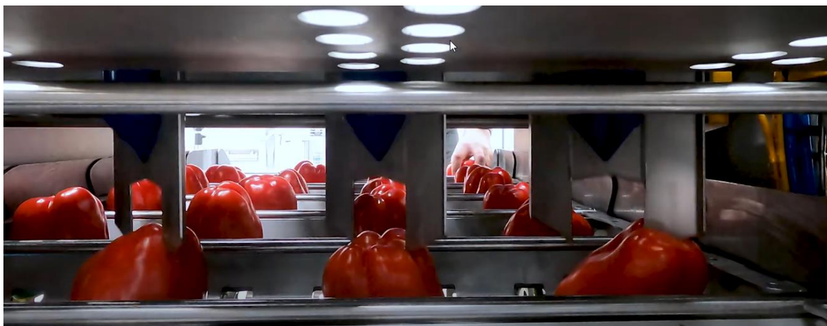
Rys. 10. Dojazd noża przecinającego paprykę na 2 części [6]
