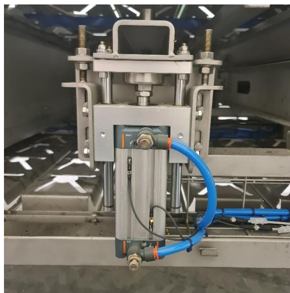
Rys. 104. Widok budowy systemu do wypychania gniazd nasiennych papryki
