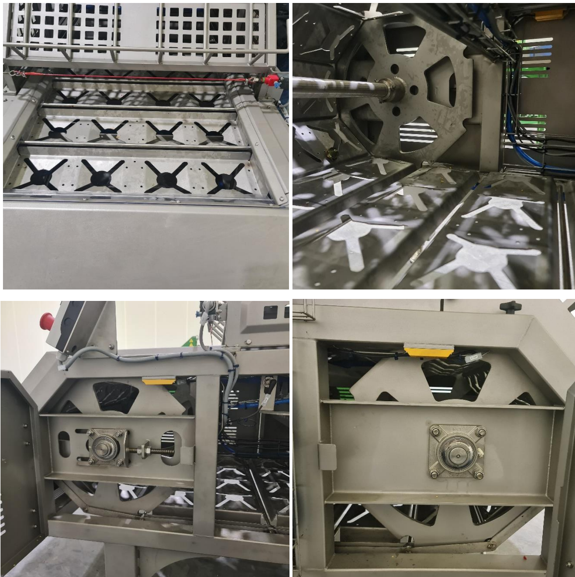
Rys. 100. Widok budowy systemu transportującego paprykę
