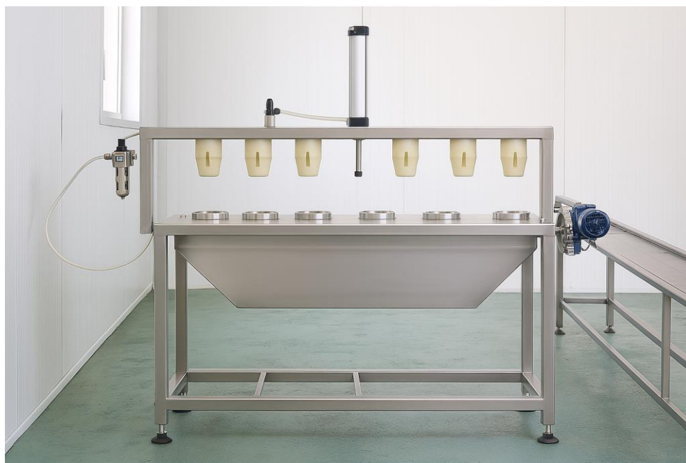
Rys. 16. Półautomatyczna maszyna do usuwania gniazd nasiennych i cięcia papryki
