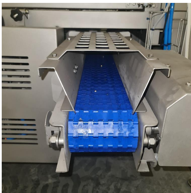
Rys. 106. Widok budowy systemu odbioru pociętych papryk
