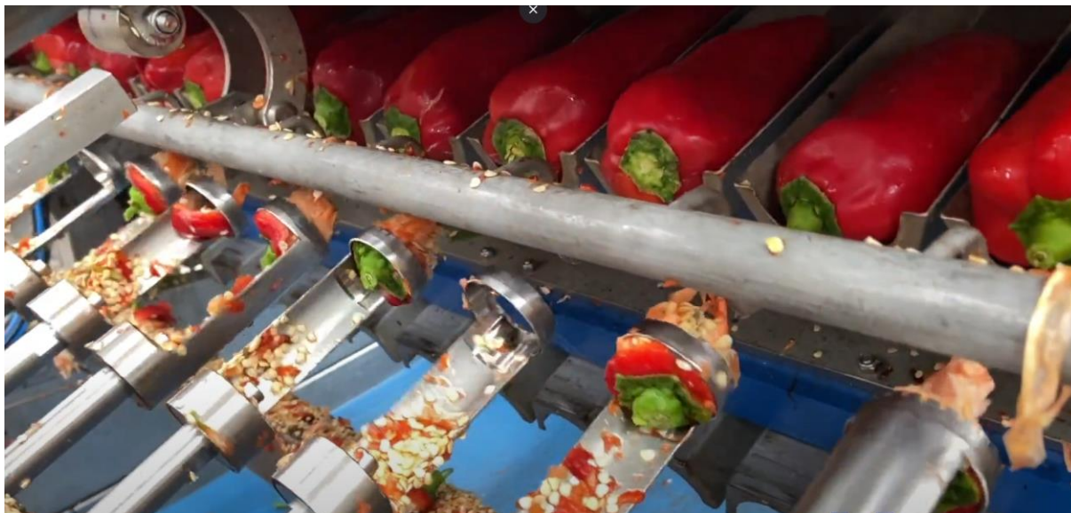
Rys. 2. Pozycjonowanie papryki przed procesem, ustawienie noży wycinających gniazda [1]
