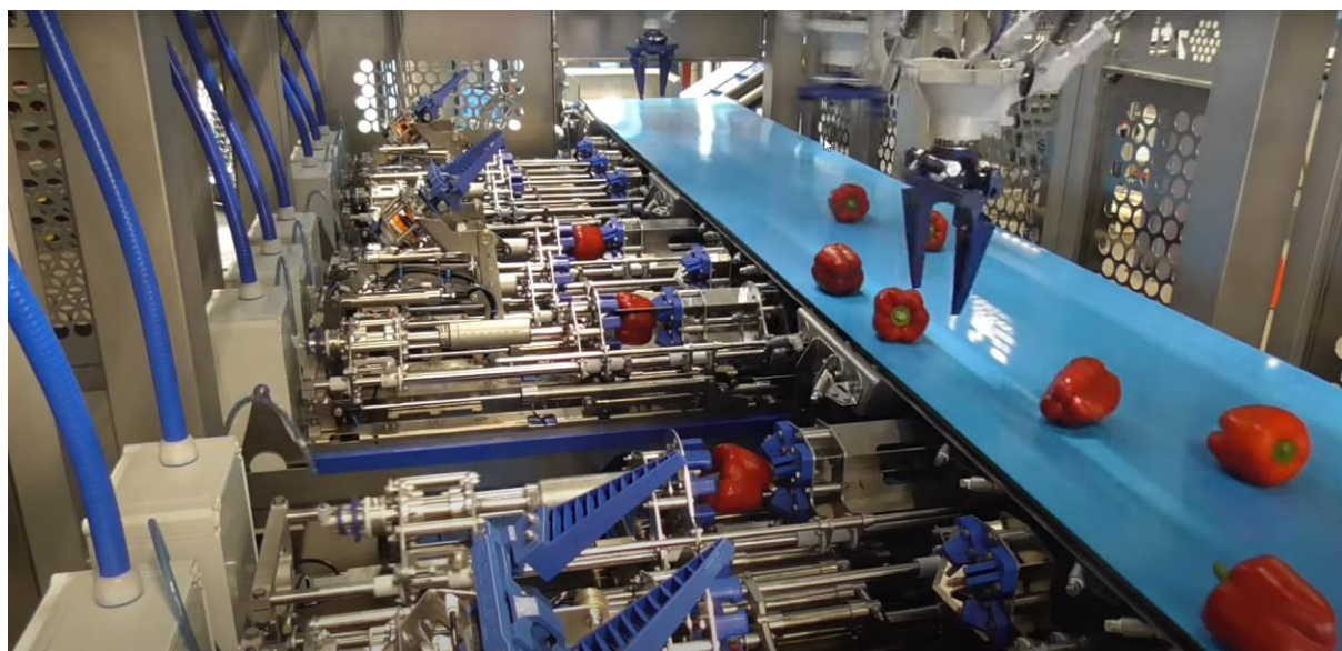
Rys. 12. Widok na cykl pracy maszyny podczas usuwania gniazd [6]
