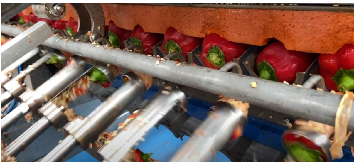
Rys. 3. Docisk papryki przed wykonaniem procesu cięcia [1]
