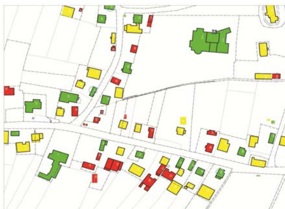
Ilustracja 9. Przykład fragmentu mapy z zaznaczonymi budynkami różnego typu i określeniem ich stanu, który został podzielony na budynki w stanie dobrym, wystarczającym i złym 108
