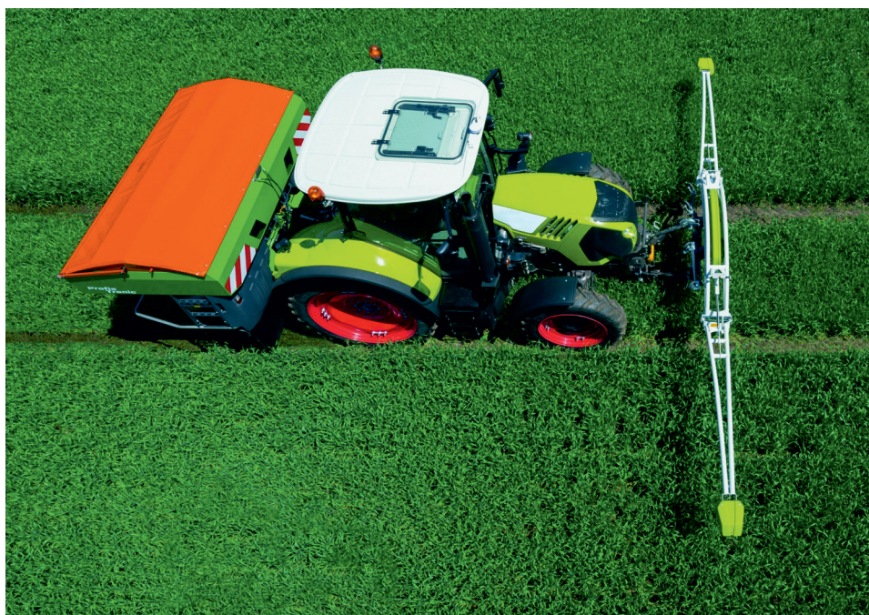
Fot. 5. Czujniki optyczne zamieszczone w głowicach z prawej i lewej strony ramienia zamontowanego na przednim zawieszeniu ciągnika (Koronczok, Agrocom)
