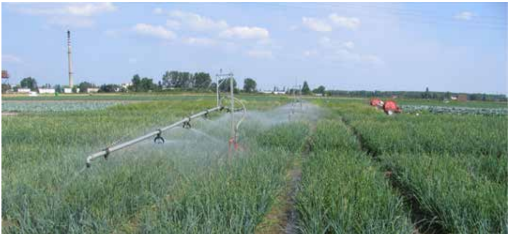
Fot. 5. Konsola deszczowni szpulowej
