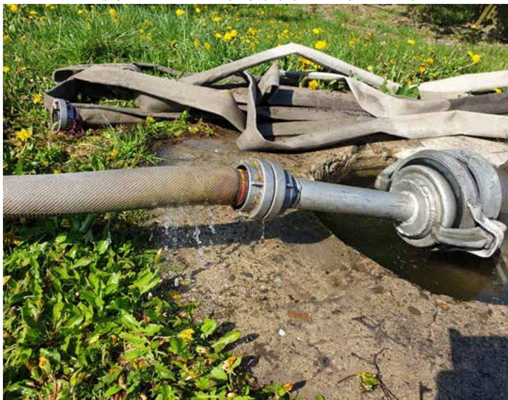
Fot.15. Taki „niewinny” przeciek w skali sezonu jest przyczyną bardzo dużych strat wody
