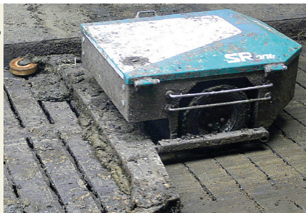
Fot. 1. Robot czyszczący korytarz z podłogą szczelinową
